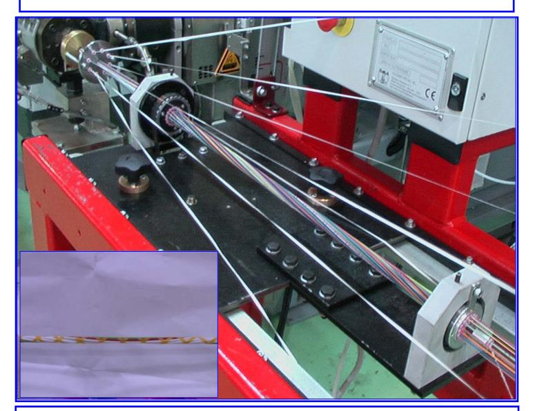
Линия предназначена для скрутки с переменным S-Z шагом микрокабелей, состоящих из оптоволокна с плотной изоляцией, или традиционных проводников.
